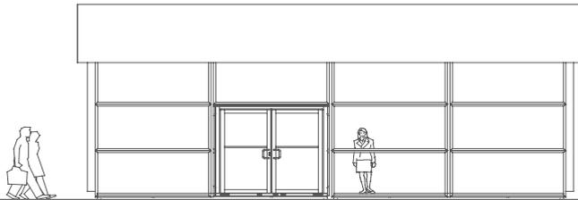
■ Beispiel Losberger De Boer Kubo 10 x 10 m mit horizontalen Glaselementen und Fassadensystem
